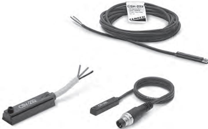
Магнитные датчики положения Серии CST-CSV-CSH служат детектором положения поршня цилиндра. Под воздействием магнитного поля поршня замыкается внутренний контакт датчика, и электрический сигнал выдает в цепь электрической катушки клапана или на вход PLC.
