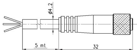
В случае, использования 2-х проводного датчика с разъёмом M8 (CST-250N, CSV-250N и CSH-253), соедините коричневый провод с "+" источника питания и черный провод с нагрузкой.
